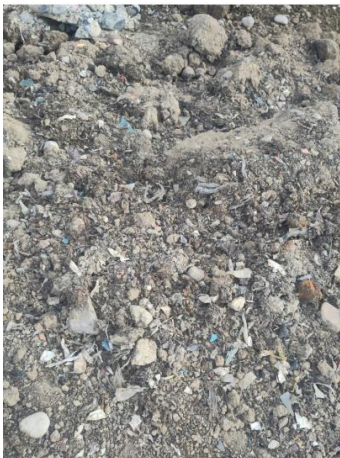
Optisch erkennbare Fremdstoffteile im Aushubmaterial
