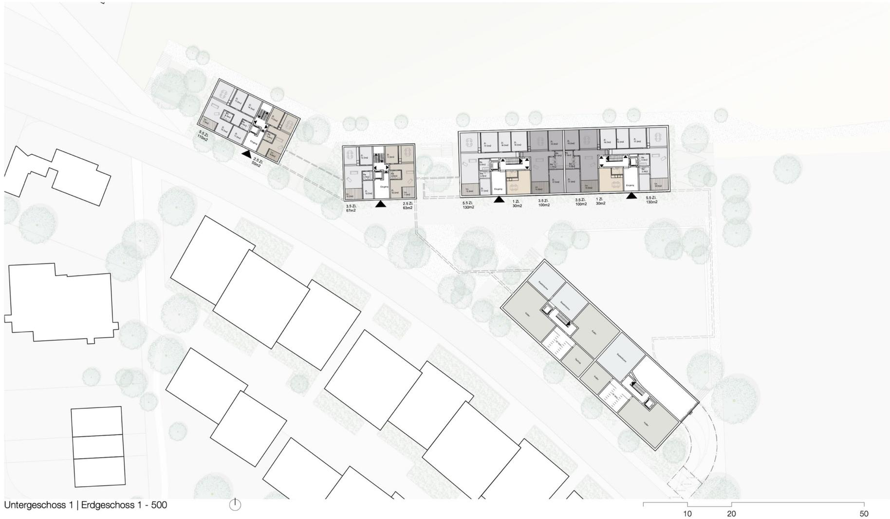
Richtprojekt Schönegg: Grundriss 1. Vollgeschosse der Häuser 2A, 2B, 3A und 3 (Erdgeschoss) sowie Untergeschoss des Hauses 1
