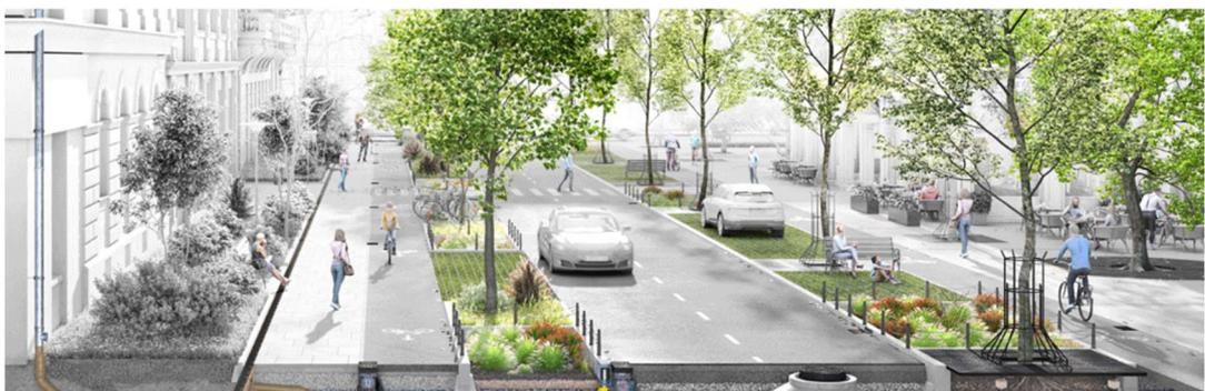
*Oberflächige Zwischenspeicherung/Versickerung mit Überlauf in Mischabwasser (Quelle: ACO)*
